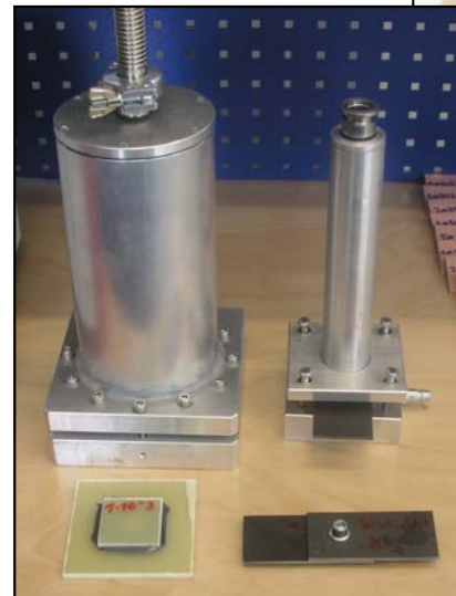
Vakuum- / Überdruckzylinder zur Dichtigkeitsmessung von geklebten und mechanisch gefügten Verbindungsproben in Verbindung mit Heliumlecktestgerät
