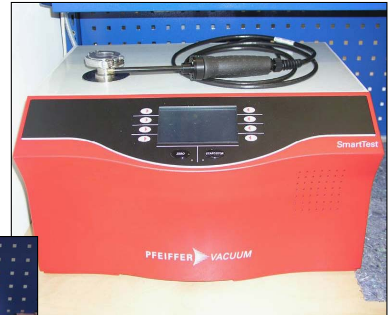
Heliumlecktestgerät HLT 160/560 mit Schnüffelsensor zur Lecksuche
