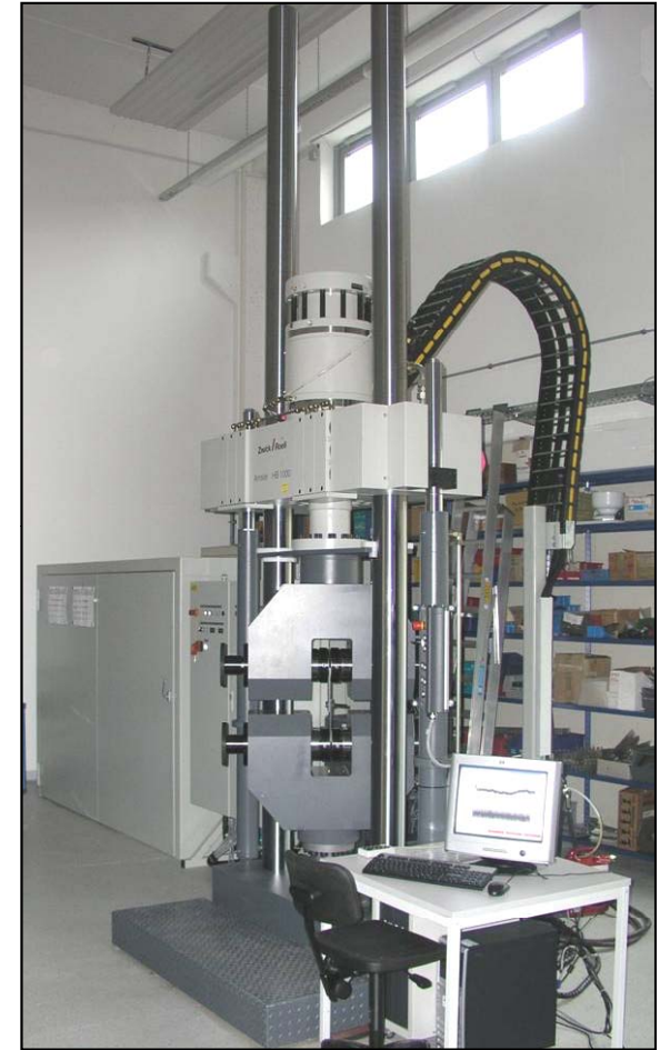
Servohydraulische Prüfmaschine HB 1000 bei Ermüdungsuntersuchungen an mechanisch gefügten Verbindungsproben
