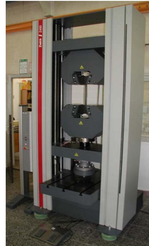
Ansicht der Prüfmaschine Z400E beim Zugversuch einer blindgenieteten Flachscherzugprobe
