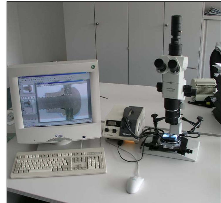
Aufnahme und Detailuntersuchungen an Makroschliffen mit Stereomikroskop Olympus SZX12
