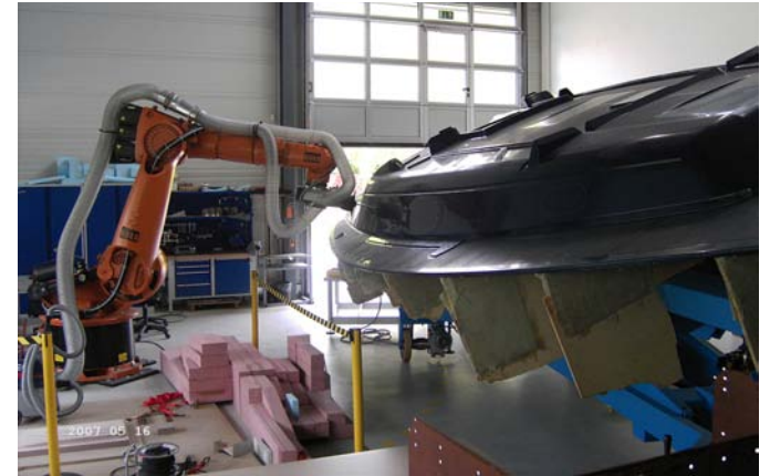
Roboter-Fräsen von großen Werkstücken in Verbindung mit flexiblem Werkstückträger
