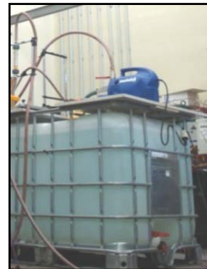
Externer Kreislauf zur Kühlung der Kupferschuhe
