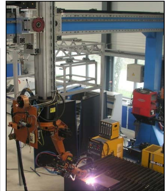
Schneidbrenner adaptiert am KR 15 am 3-achsigen Portal
