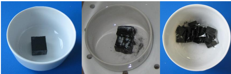
Textilglasverstärkte Kunststoffe-Bestimmung des Textilglas- und Mineralfüllstoffgehaltes, Kalzinierungsverfahren
