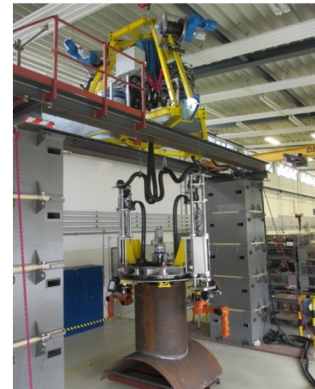
Laboraufbau der Rohrknottenschweißanlage
