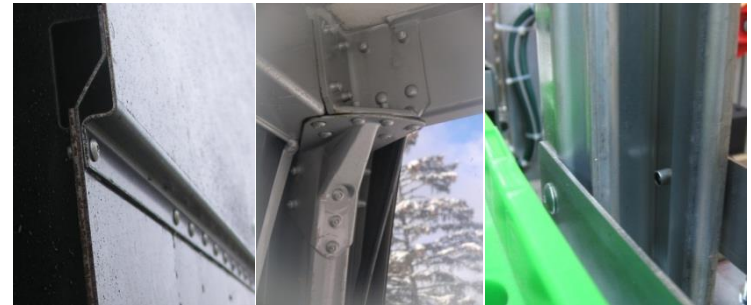
Einsatz von Blindnietverbindungen in unterschiedlichen Technikbereichen: Schienenfahrzeug – Seilbahngondel – Hochregallager (v. l. n. r.)
