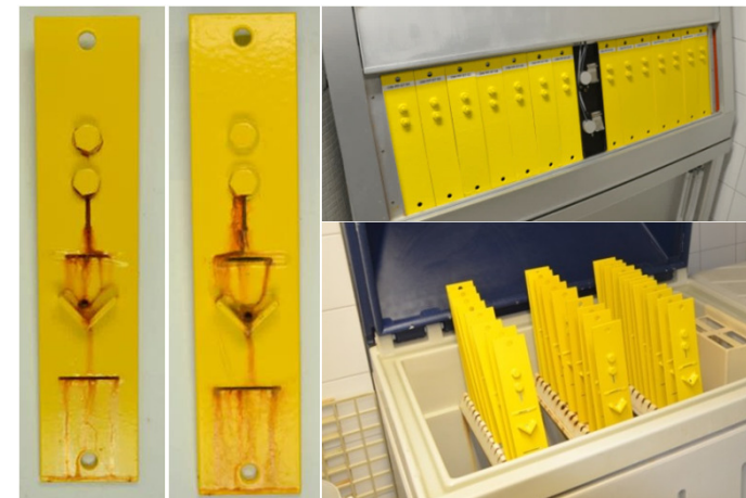
Komplexe Prüfkörper mit versch. Beschichtungssystemen während der UV-Kondensationsbeanspruchung und im Salzsprühnebeltest
