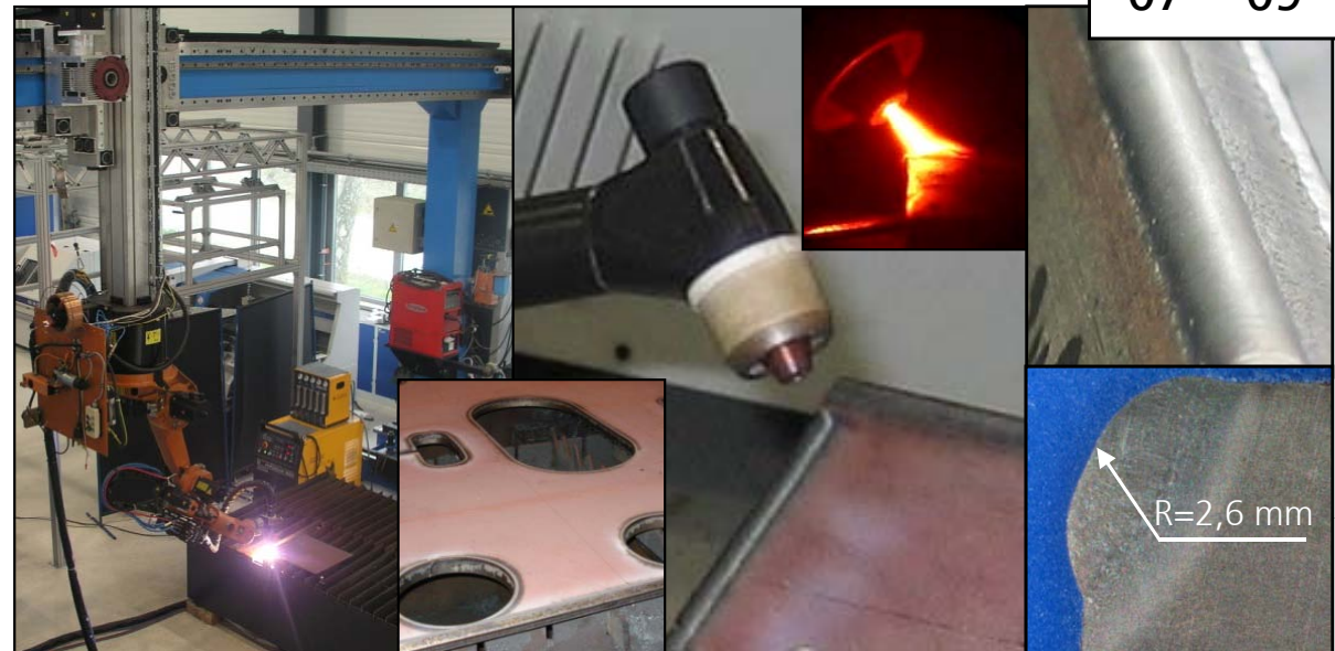
Versuchsaufbau: Plasmaschneid- und Plasmaschweißbrenner beim Schneiden und Runden (Bild links und Mitte) schiffbaulicher Probenteile (kleines Bild Mitte unten); Plasmaschweißlichtbogen im Einsatz (kleines Bild rechts oben) für das parallele und nachgelagerte Kantenrunden schiffbaulicher Strukturen (Bild Mitte unten); mittels Plasmaschweißverfahren gerundete Kante mit Schlibbild (Bilder rechts)
