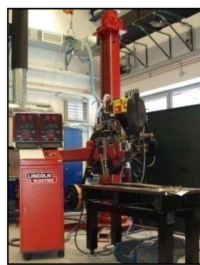
UP-Inverteranlage mit Mast (Fa. Lincoln Electric) in Tandem TwinArc-Anordnung
