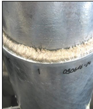
Gelötete Ballastwasserrohre vor und nach dem Bauteilzugversuch
