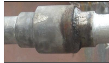
Derzeitige Montagereihenfolge: MAG-Schweißen Innenmuffe, Verzinken, Verzinkung entfernen an Innen-/Außenmuffe, MAG-Schweißen, Nachverzinken
