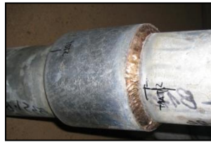
Derzeitige Montagereihenfolge: MAG-Schweißen Innenmuffe, Verzinken, Verzinkung entfernen an Innen-/Außenmuffe, MAG-Schweißen, Nachverzinken
