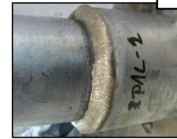
Angestrebte Reihenfolge: Verzinken, MIG-Löten
