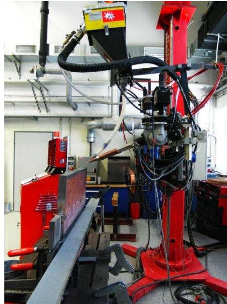
UP-Versuchsstand für PC-Mehrdrahtschweißung
