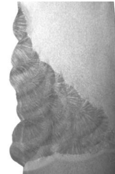
Makroschliff UP-PC-Schweißung in Tandem-Twin-Prozess
