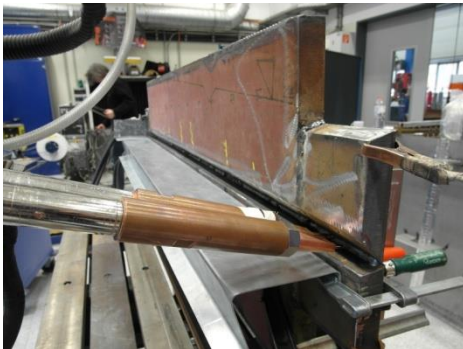
Tandem-Twin-Arc-Schweißkopfanordnung für Versuchsschweißung in PC
