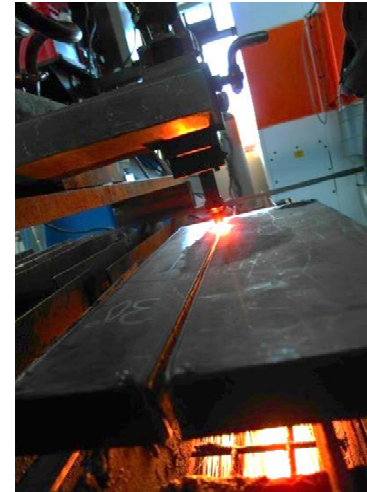
Brennversuch mit Azetylen/Sauerstoff an 60 mm Baustahl
