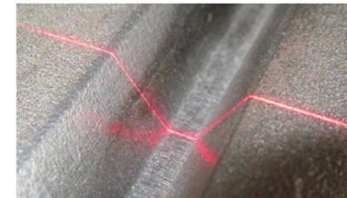
Erfassung der Schweißfugen-geometrie mittels Laserlinienschnitttechnologie zur Nahtverfolgung beim Mehrlagen-MSG-Schweißen
