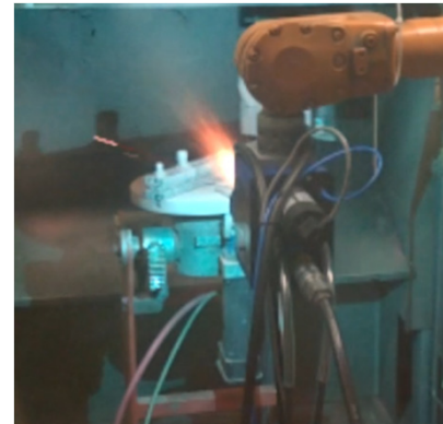
Lichtbogenspritzversuch zur Optimierung der Prozessparameter und Werkstoffigenschaften
