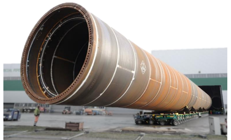
UP-geschweißtes Monopile aus Grobblech als Offshorewindenergieanlagen-Gründungsstruktur
